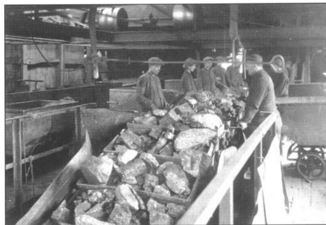
Die Aufbereitungsanlage in Mittelbexbach. Am Klaubeband wurden die Steinkohlen vom tauben Gestein getrennt.
